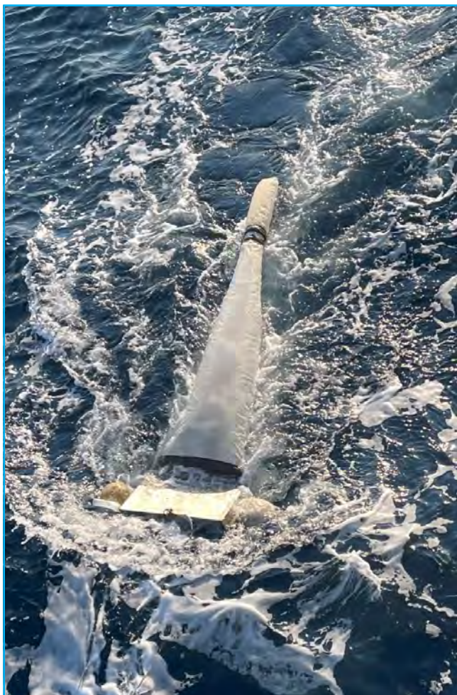
Рис. 7. Выполнение нейстонных тралей модифицированной сетью Манты (НПО «ДЕКО») для сбора проб микропластика на НИС «ТИНРО» в Тихом океане в феврале-марте 2022 г.
